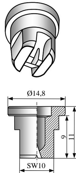
Fig. 2. b) TeeJet nozzle inlet
